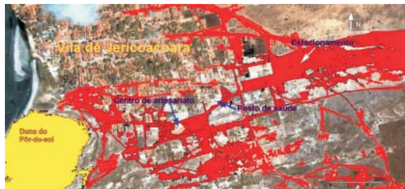
Figura 8 – Detalhe do Movimento dos Sedimentos que Atualmente Migram no Setor Urbanizado da Vila de Jericoacoara. Parte deste Material foi Deslocado a partir do Incremento do Tráfego de Veículos e Intervenções Relacionadas com o Projeto de Requalificação Urbana da Vila (Imagem de Satélite Quick Bird, 2005, IBAMA)
