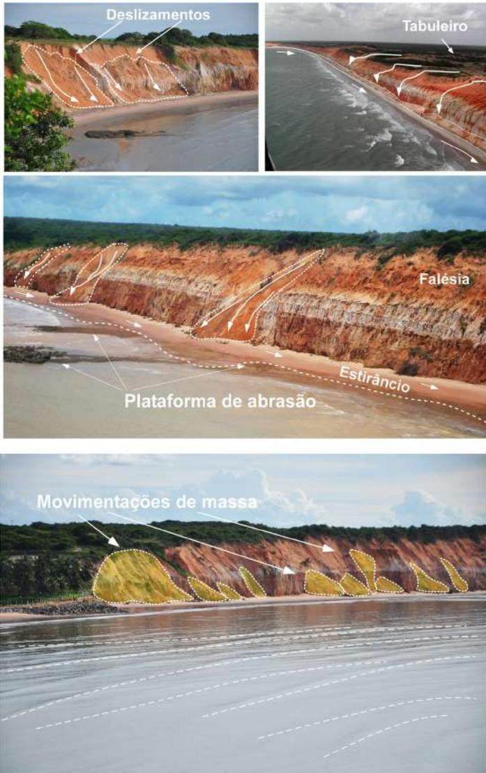
Figura 5.1 – O movimento de materiais (deslizamentos, desmoronamentos, desprendimentos de blocos e escorregamentos) e a direção predominante das ondas promovem a erosão do sopé da falésia e a indução dos movimentos de massa.
