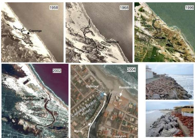
Figura 2.7 – Mostra a evolução do riacho Caponga a partir dos meandros localizados na desembocadura. Evidenciou-se que os diques de enrocamento artificializaram o canal de modo a restringir seu leito para um único eixo de deságue no mar. Acarretaram danos ambientais relacionados com a ocupação da área de preservação permanente (APP) e diminuição de seu potencial de transporte (barramento da foz com areia proveniente da faixa de praia e estagnação da água acumulada em sua bacia hidráulica).
