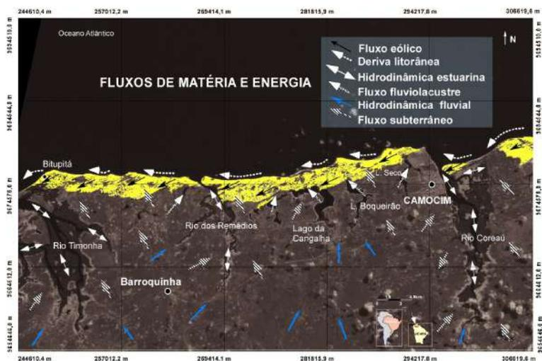
Figura 3.3 – Conjunto dos fluxos de matéria e energia ao longo do campo de dunas de Camocim. O fluxo subterrâneo foi associado ao campo de dunas, tabuleiro pré-litorâneo e sistemas fluviomarinho e lacustre (imagem Landsat, 2008).
