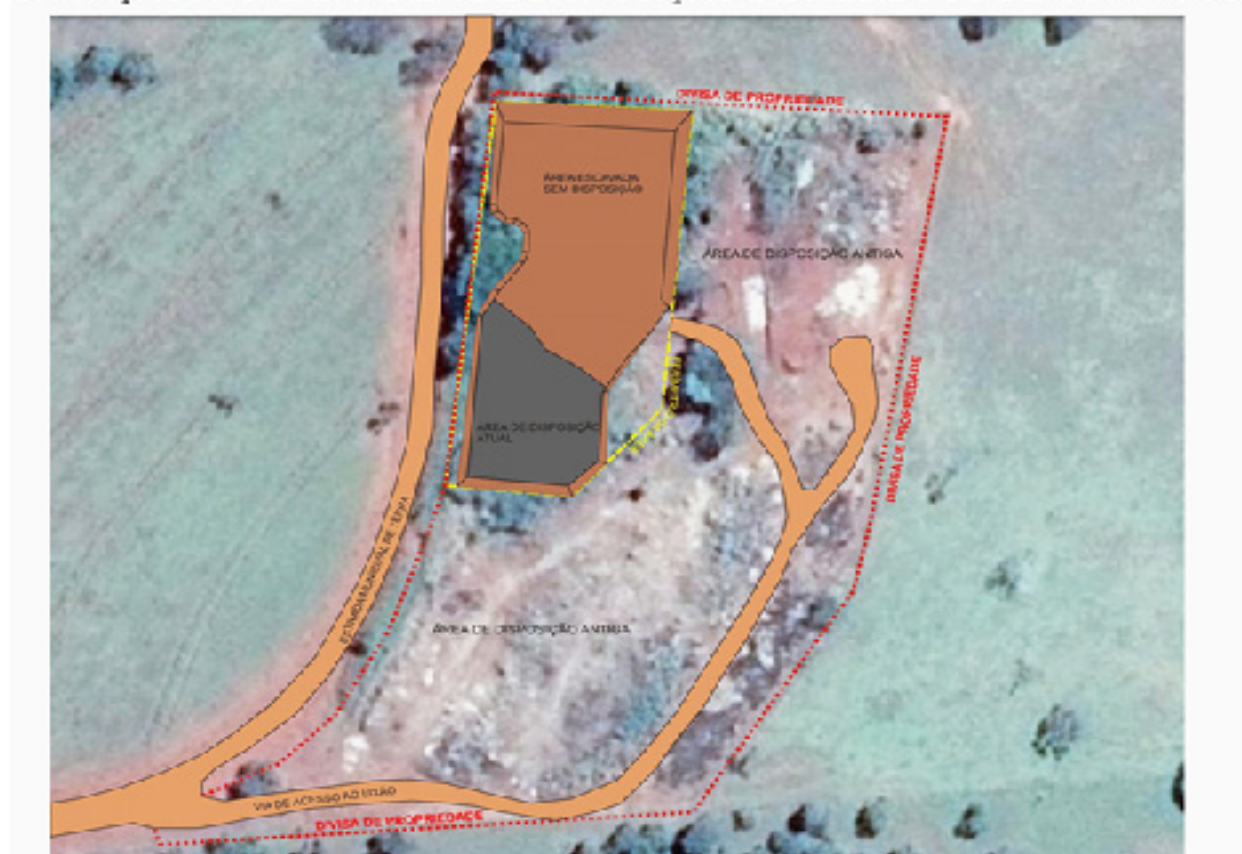
Figura 2 – Situação atual da área de disposição de resíduos sólidos gerados em Gurinhatã-MG.
