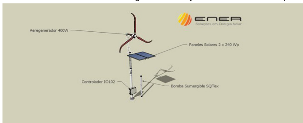
Figura 3 Sistema de Bombeamento de água (Eólico e Solar) Fonte: ENER Brasil (2013).
