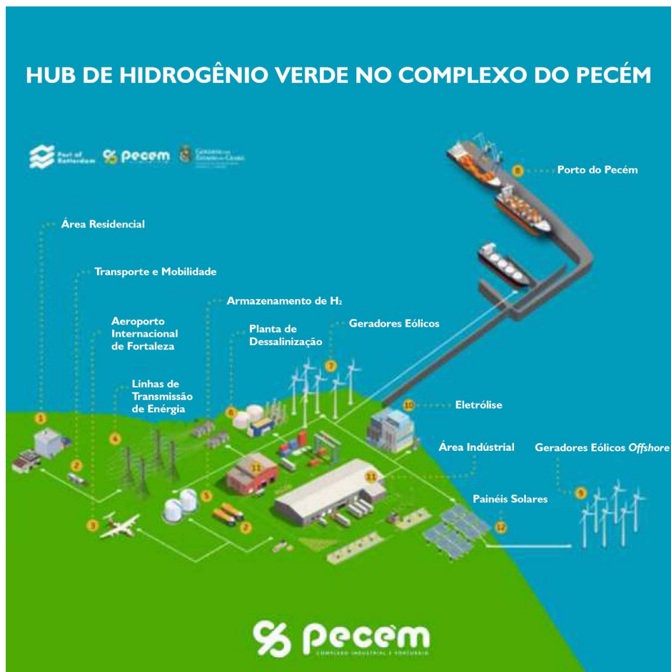
Figura 1 - Imagen elaborada por Porto do Pecém que configura una idea esquemática del hub de hidrógeno verde en el Complejo Industrial y Portuario del Pecém
