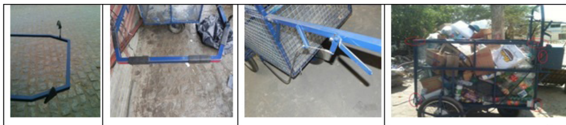
Figura 1: A-Retrovisores que auxiliam na visualização do entorno; B- Pegas revestidas de polietileno oferecendo maior conforto e segurança; C- Freio tipo alavanca; D- Faixas refletivas que auxiliam a visualização dos catadores de materiais recicláveis nas ruas.
