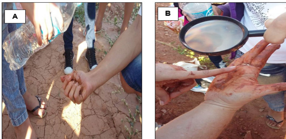
Figura –5: Testes de consistência de amostras de solos (A.B).
